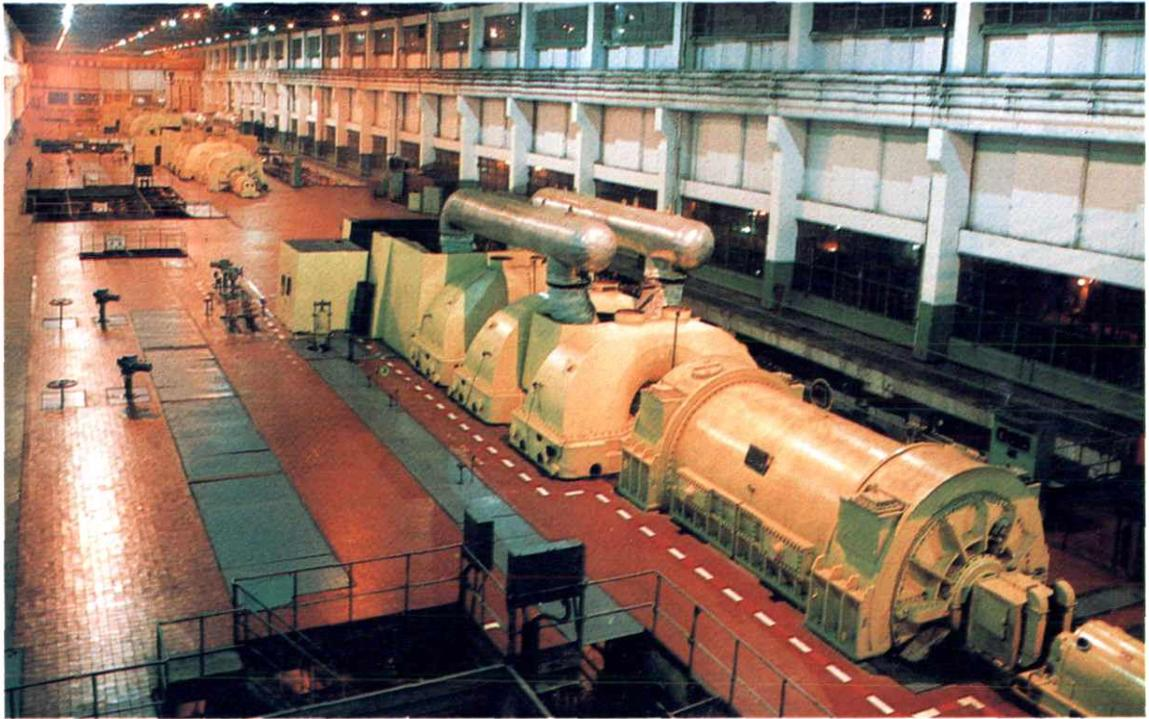
镇海发电厂 20 万千瓦汽轮发电机组
