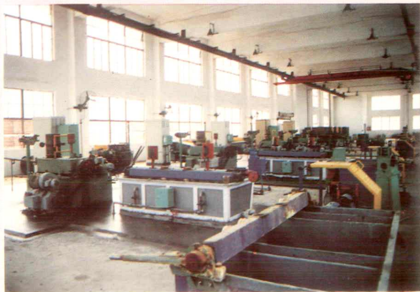
▷ 自贡中国电焊条厂镀锌焊 丝生产线
