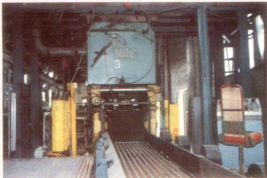
◁ 自贡空压机厂引进丹麥迪 砂自动造型机
