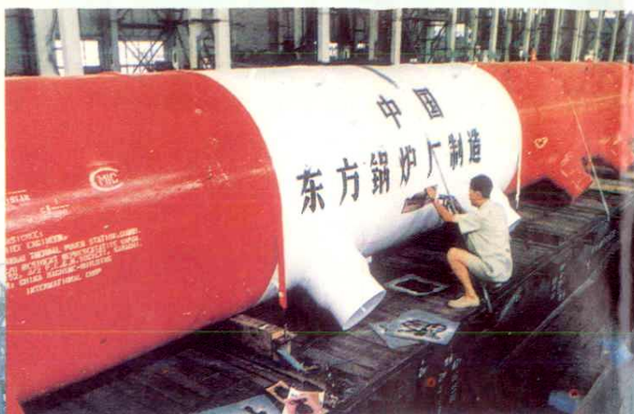
△东方锅炉厂为巴基斯坦古杜电厂四号机组生产的锅炉汽包出厂
