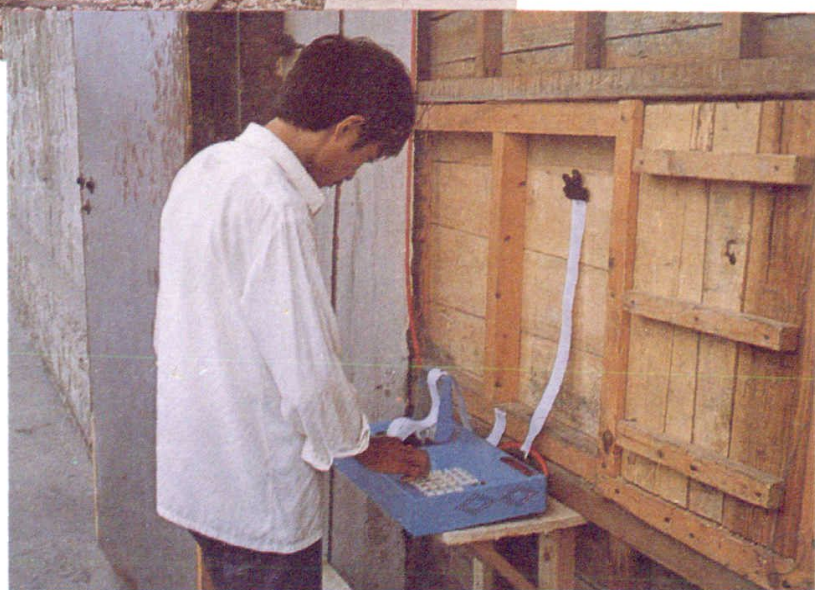
9. 新海粮库职工用电子巡回测温仪测量储粮温度
