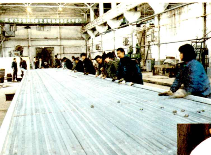
管束车间进行空冷散热器的管束组装
