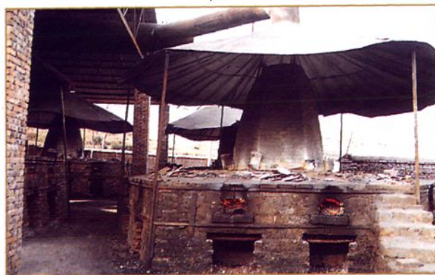
冶炼粗锌的环保炉
