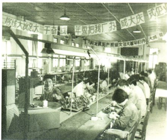
七十年代，国光自主设计的带式扬声器装配线。
