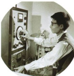
七十年代，时任技术员，现为公司总工程师俞锦元用丹麦测试仪检测扬声器。
