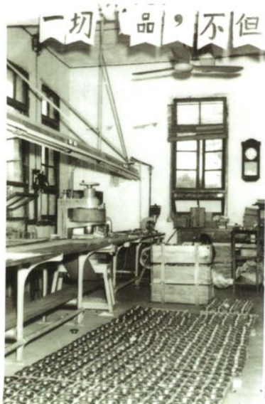
排在地面的是当天下午装好的磁路系统和盆架，在六十年代的胶黏剂需要五六个小时才能干透，所以利用下班后车间空地排开，第二天一早上班就收起来，再进行下一工序装配。
