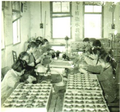
六十年代，板装手工传递式扬声器装配线。
