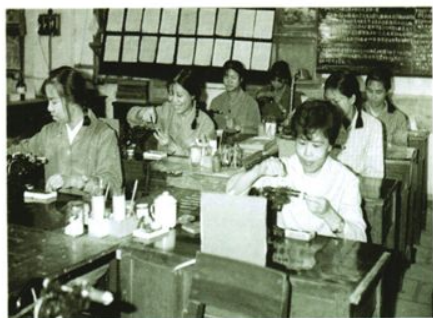
七十年代，音圈班员工在绕音圈线。
