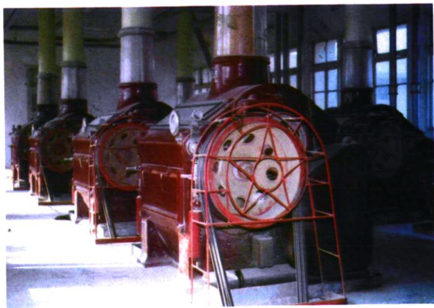
城关面粉厂加工设备800型磨粉机
