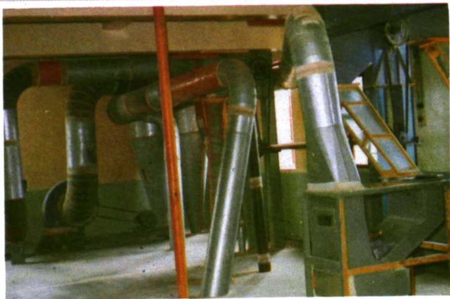
城关米厂大米车间加工设备去石机
