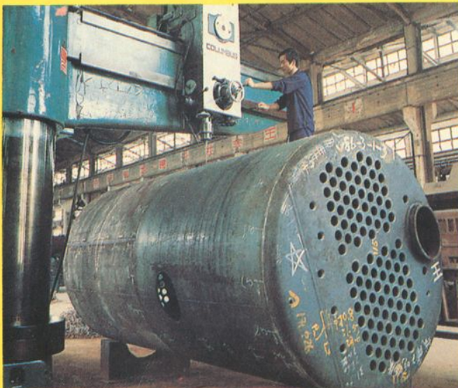
4 吨 锅 筒 正 在 加 工
