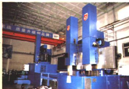
公司新购置的2米数控加工中心和2.5米数控立车
