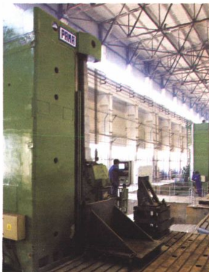
公司新购置的意大利PAMA直径200毫米的数控镗铣床
