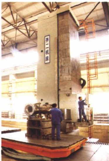
公司新购置的国产直径260毫米的数控镗铣床
