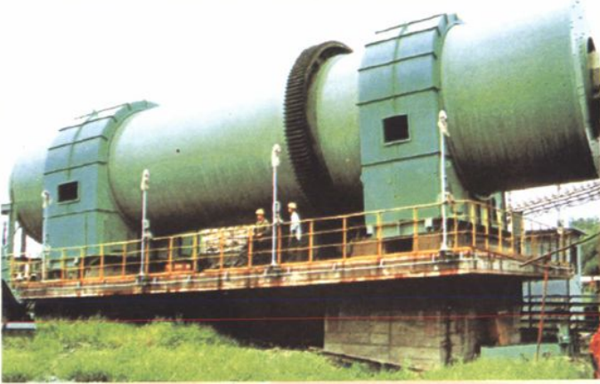
为宝钢制造的国内最大的圆筒式混合机
