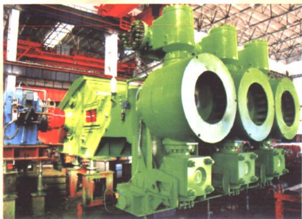
为中国黄金集团制造的目前国内最大流量DGMB450/8的隔膜泵
