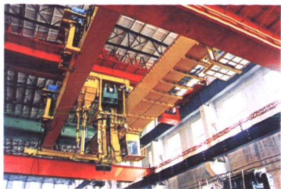
为四川启明星铝业有限责任公司生产的 带有清渣机构的铝电解多功能机组
