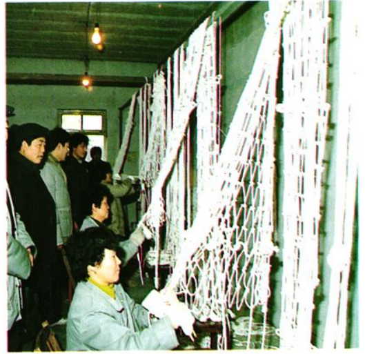
安全網生產車間
