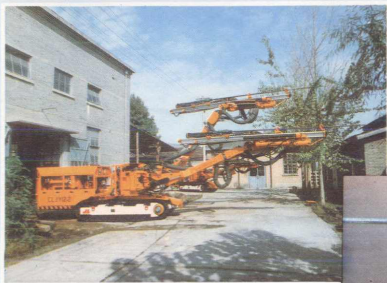
天水风动工具厂CLJY12·2全液压履带式掘进钻车
