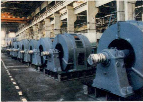
兰州电机厂大型异步电机
