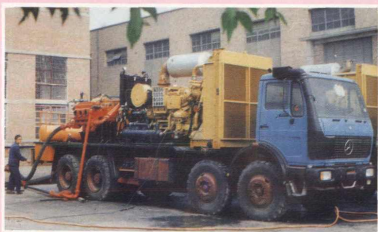
兰州通用机器厂 YLC-1050 压裂车
