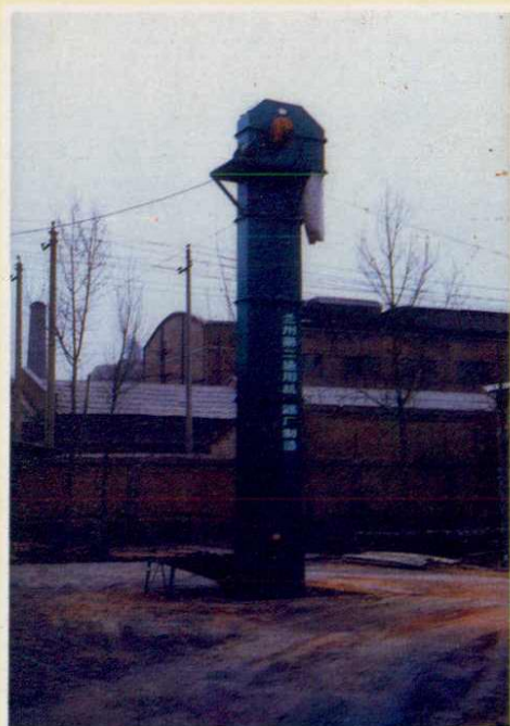
兰州第二通用机器厂TD-250型斗式提升机
