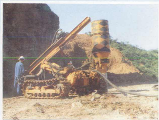
天水风动工具厂CLQ15型履带式潜孔钻车
