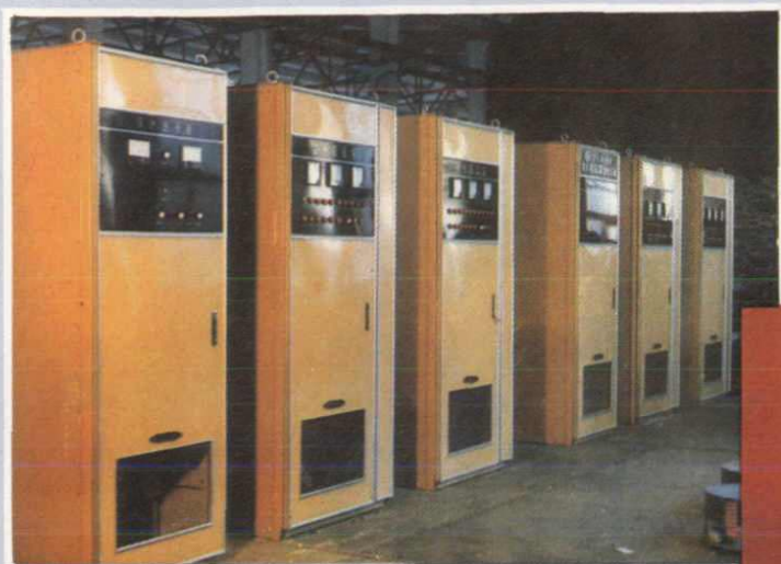
天水电气传动研究所研制的矿井提升机电控装置
