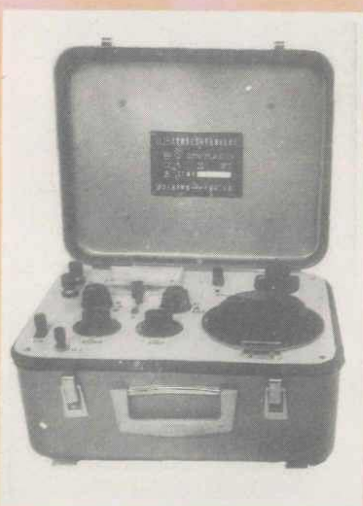
天水长城电工 仪器厂UJ54携 带式直流电位 差计
