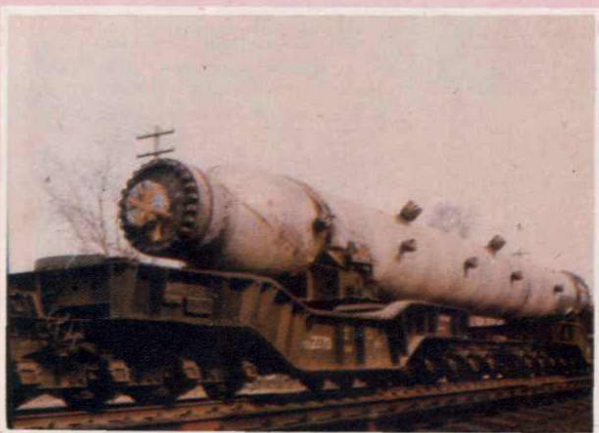
兰州石油化工机器厂为炼油厂研制的热壁加氢反应器
