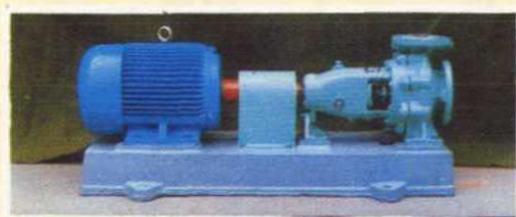
兰州水泵厂IS型单级单吸离心泵
