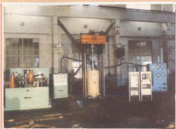
天水红山试验机厂1000KN电液伺服动静三轴试验机
