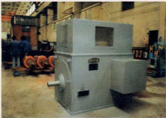
兰州电机厂中型10KV交流电动机
