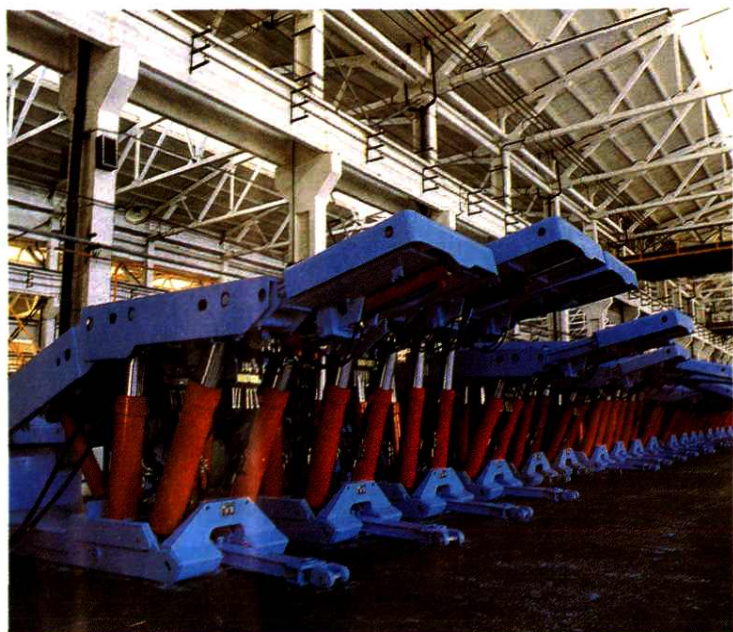
郑州煤矿机械厂整装待发的综采液压支架
