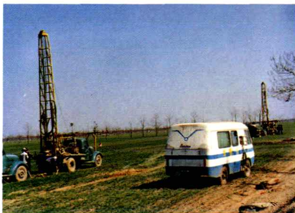
物探队在永夏煤田进行地震勘探
