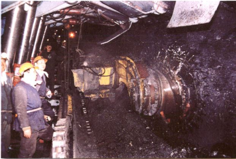
综采机组在割煤
