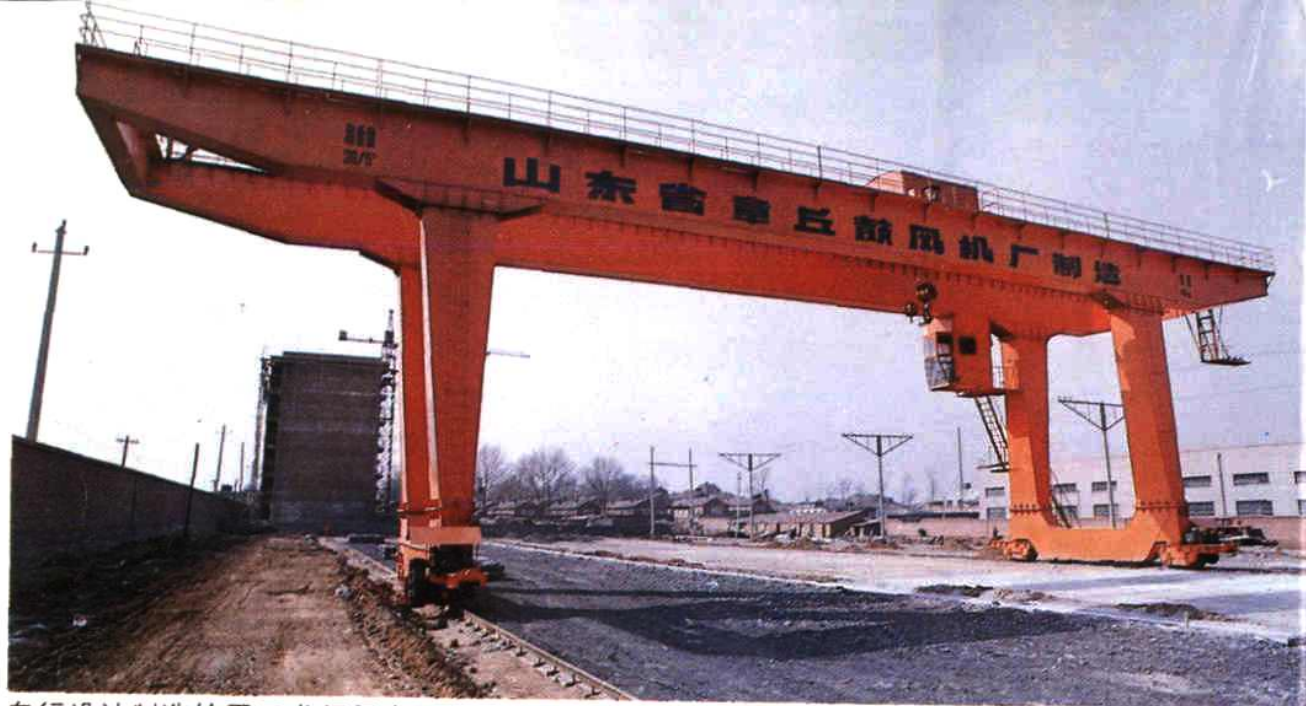
自行设计制造的露天龙门吊车
