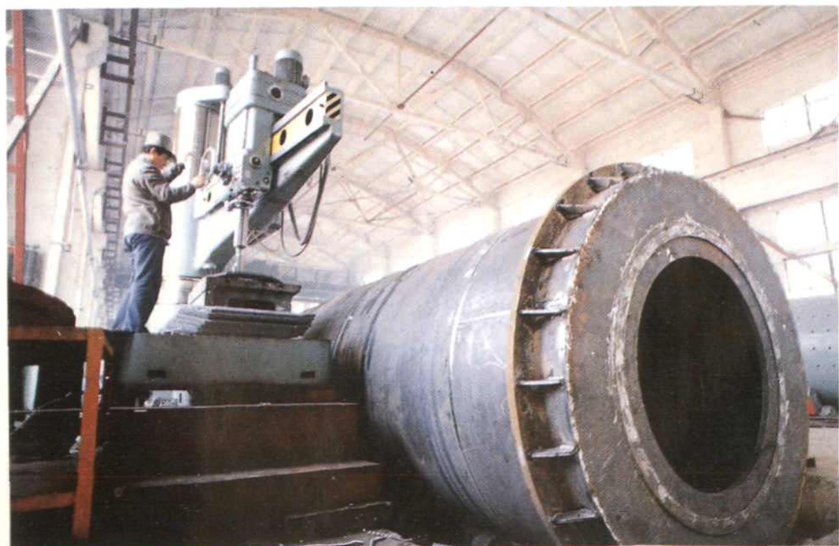
加工球磨机主体滚筒现场
