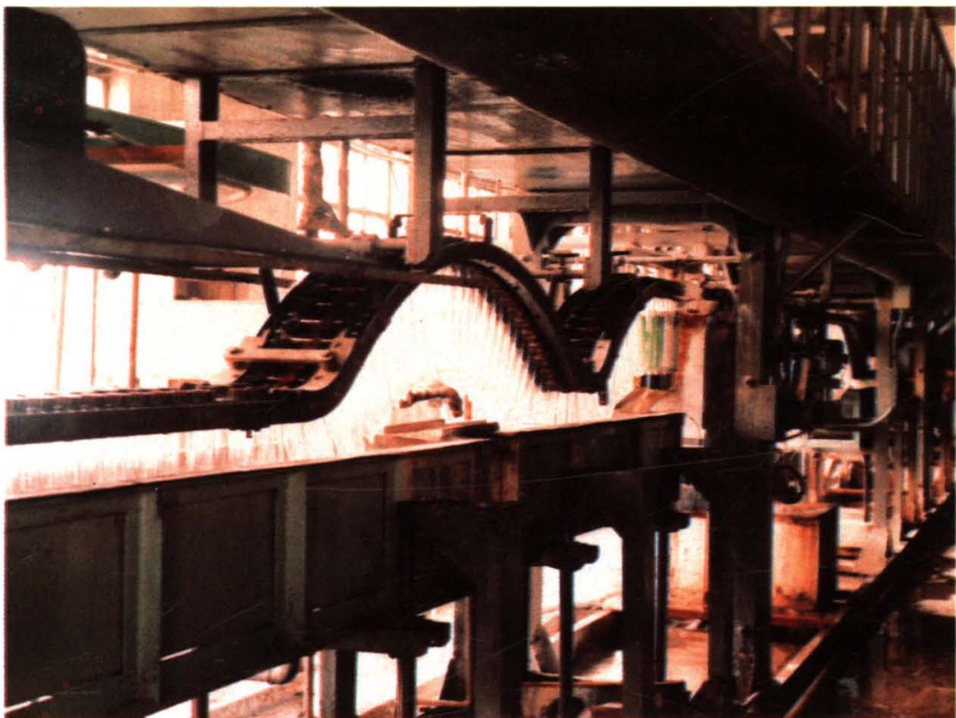
六十年代橡胶工业托拉斯时期开发的乳胶制品联动生产检验装置。
