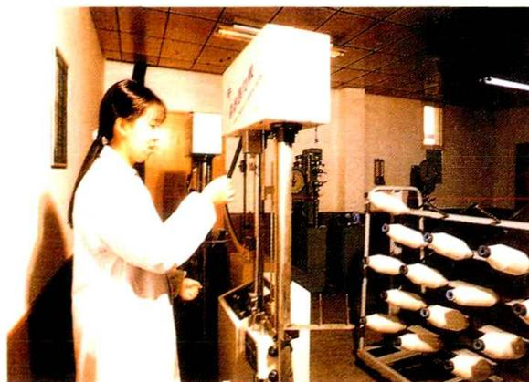
绍兴市纤维检验所技术人员在检验化纤长丝
