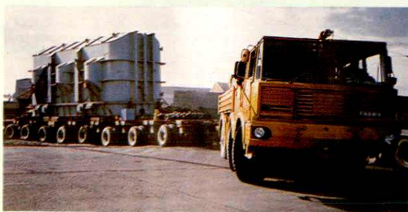
浙江省火电建设公司用 200 吨大型平板车将镇海发电厂一期工程的主变压器运抵工地
