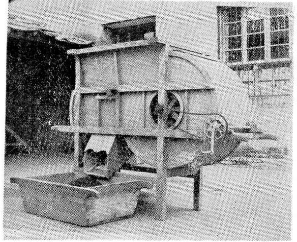
图十一、铁链土风车
