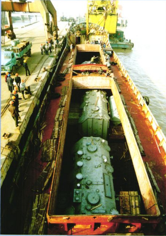
220千伏芙蓉变电所主变压器由水路运至 江阴(1998年摄)
