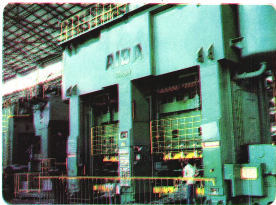
从日本引进的2000吨多工位压力机
