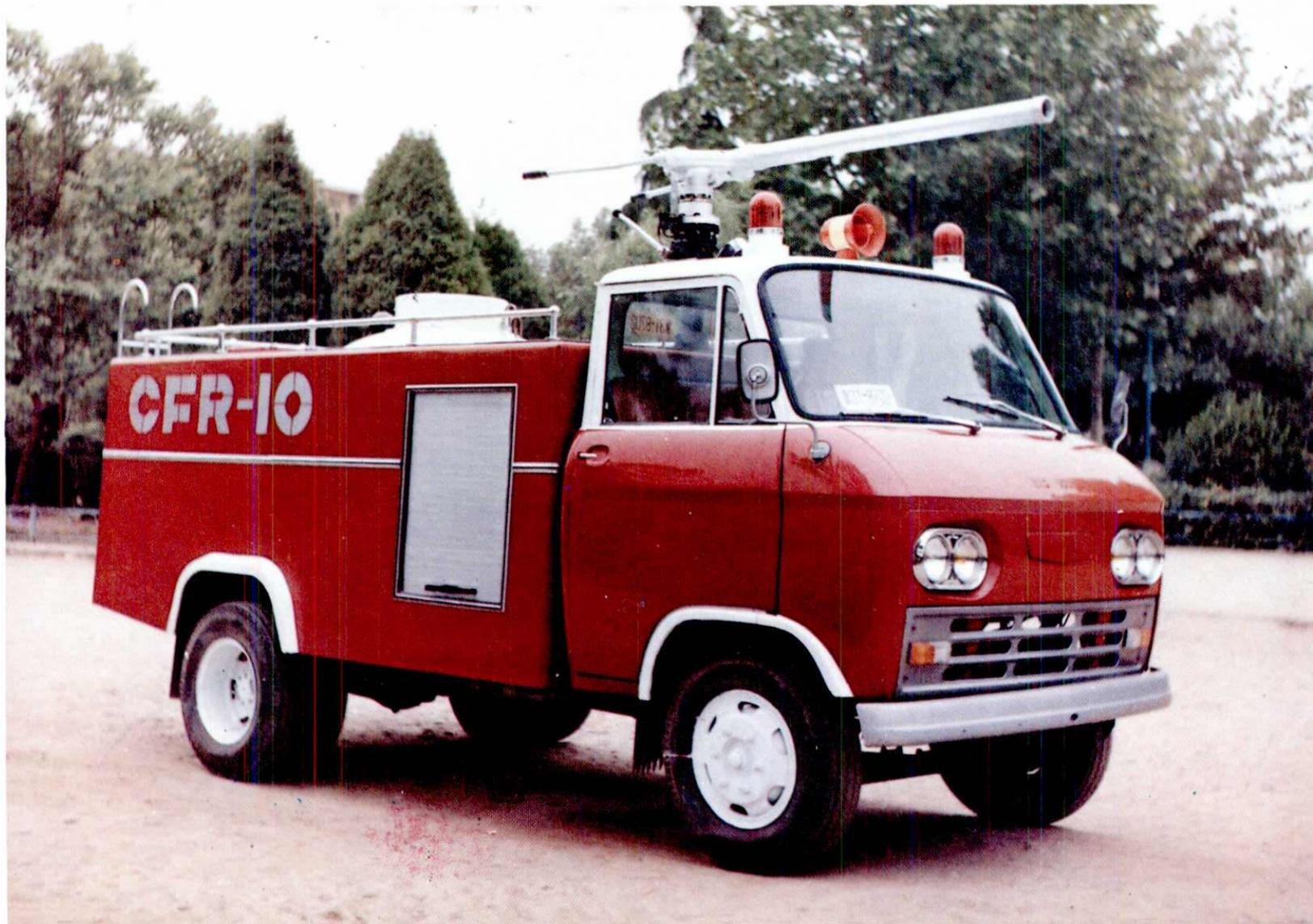
CFR10型燃气式干粉消防车
