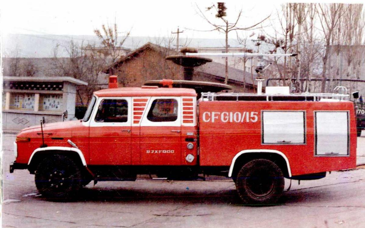
CFG10/15型干粉水雾联用消防车（1987投产）
