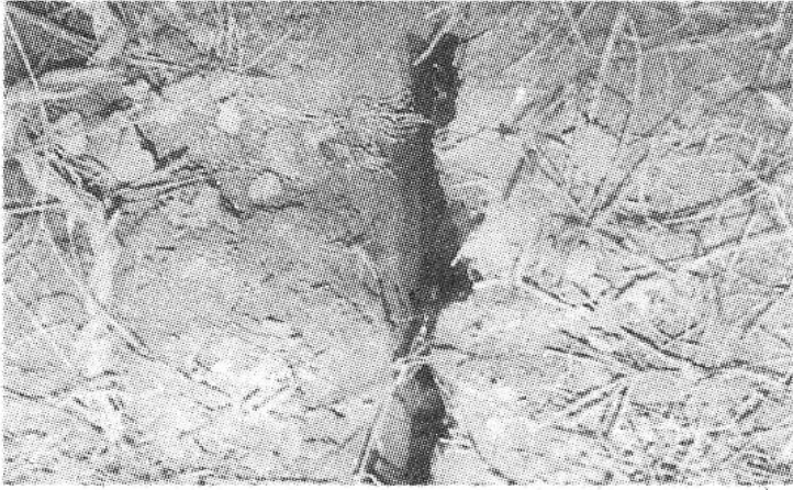
八府庄北农田。农田地表呈锯齿状开裂，缝宽10厘米，可见深度1.5米，显示张性特征。（镜向：垂直）
