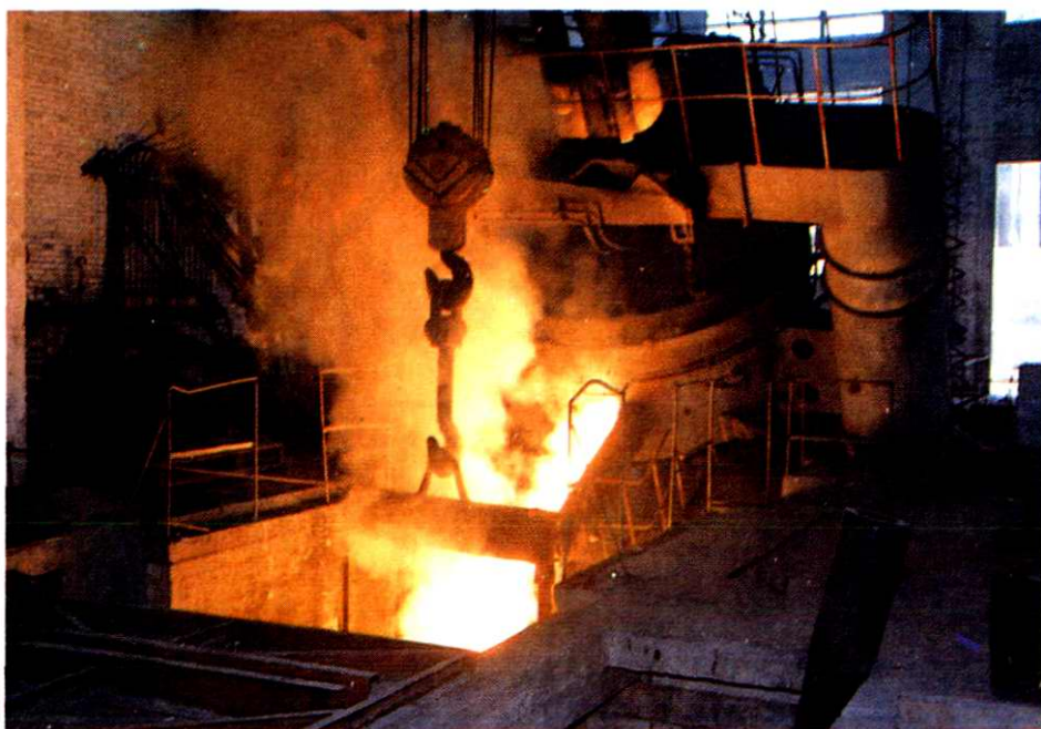
宝鸡桥梁厂的五吨电炉在炼钢
