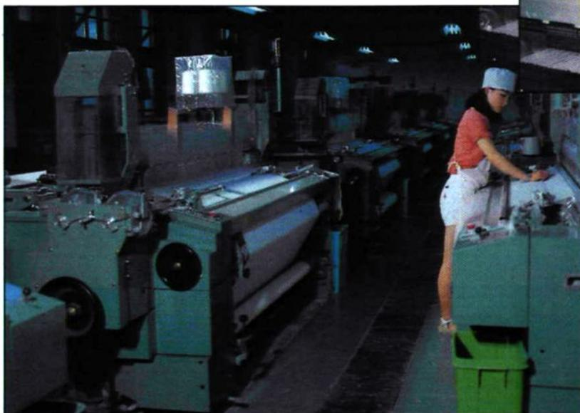
◀图 16 咸阳纺织机械厂生产的 ZA202 型喷气织机，1986 年在国棉一厂中试。右上图，该机在展览会上。
