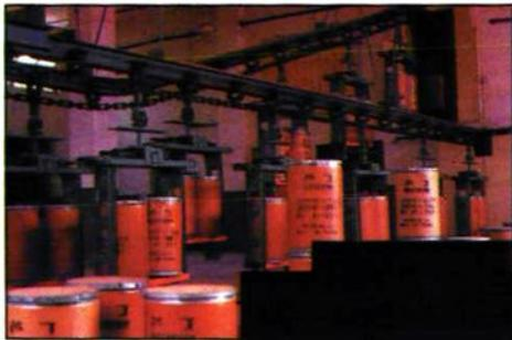
◀图 23 陕西第一毛纺织厂的钴 60 辐射法羊毛消毒装置。
