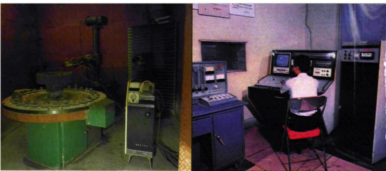
▲图 17 咸阳纺织机械厂研制的 B5 同步锤击式等离子喷涂微细粉送粉器及喷涂机床。右图为监控室。
