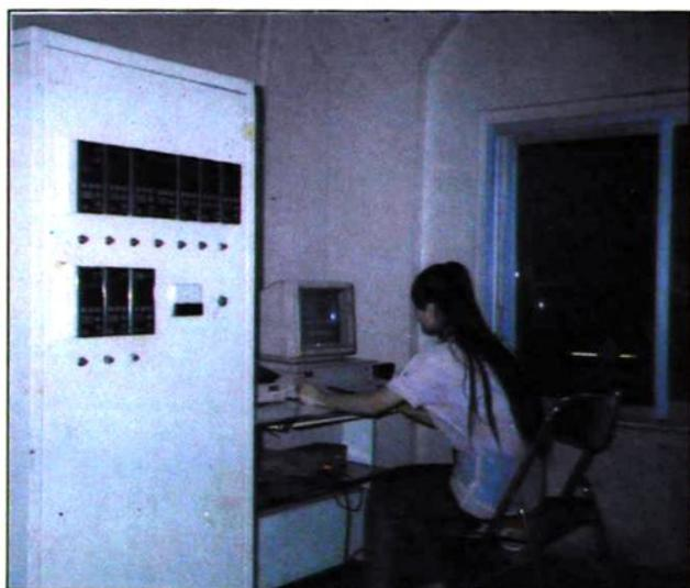
▲图 25 榆林毛纺厂的微机染色工艺控制系统,左图为染机自动调节机构,右图为监控室
