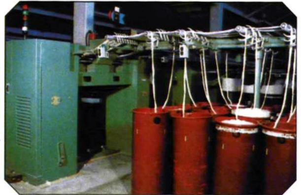
▼图 13 远东机械制造公司研制的 FA611(QF-1)型气流纺纱机
