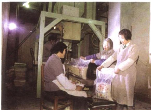
松江粮油机械厂生产的大米自动计量包装机
