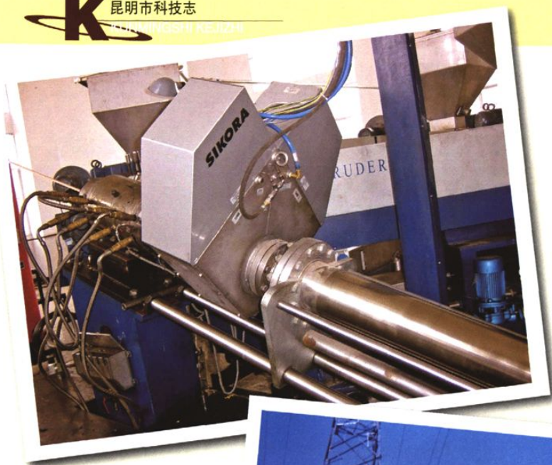
昆明电缆股份有限公司新建 6~35kV 0+3干法交联电缆生产线
