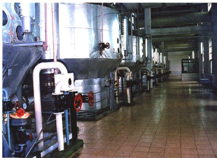
昆明克林轻工机械有限 责任公司生产的间歇结晶罐
