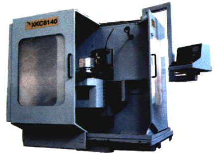
昆明三龙机械集团有限公司制造的XKCB140数控万能工具铣床
