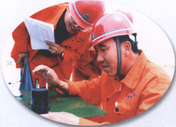
现场调试泥浆
