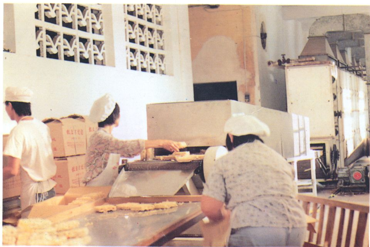
日产6吨的波纹面生产线
