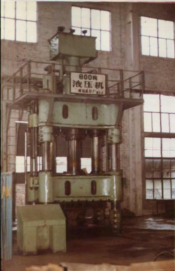
▲ 机械总厂自制的 800 吨液压机
