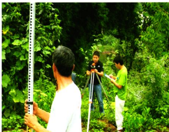
工程技术人员测量村级公路
