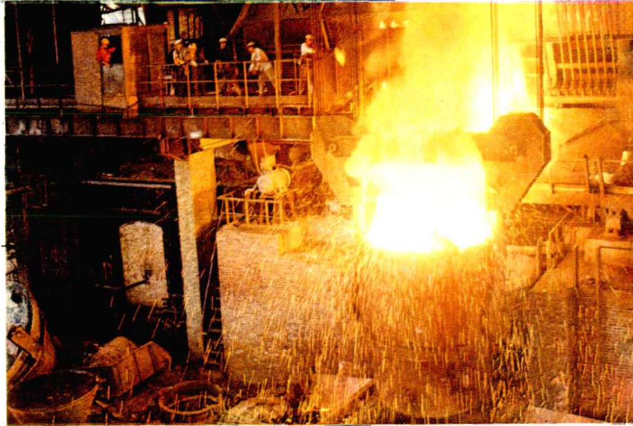
星落银河 → 200 吨平炉正在出钢
