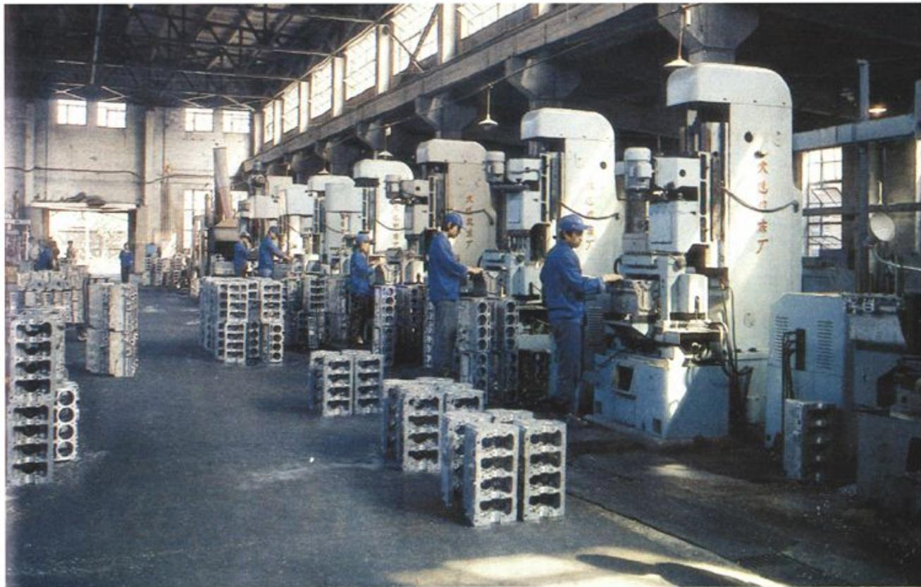
S Y 492 Q型汽油机气缸体生产线
