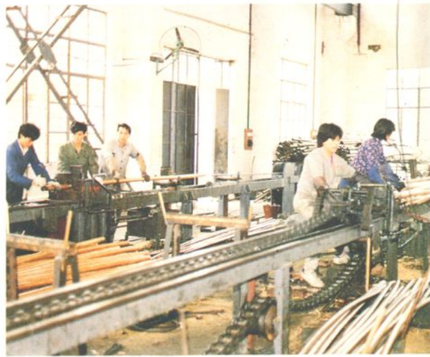
▽ 與上海鋼管一廠聯營的滬華銅管廠拉伸車間
