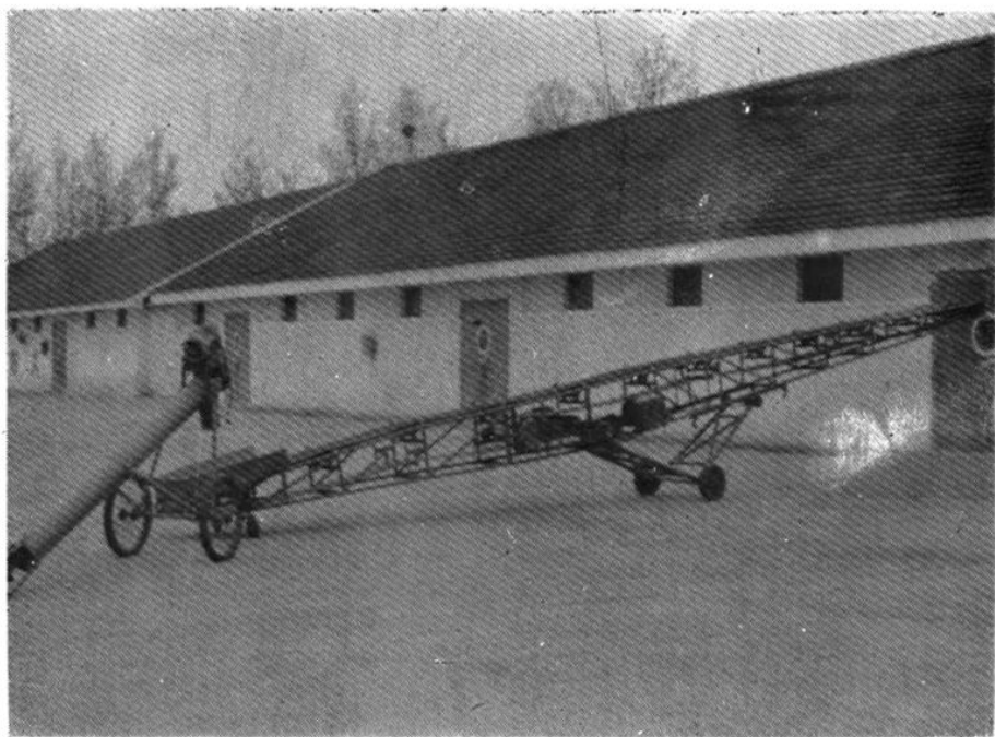
刘家庄粮所苏式仓房。县仿制绞笼式扒谷机、15米输送机
