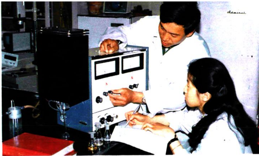
吉林省药检所用 火焰光度计测定青霉 素钾离子浓度
