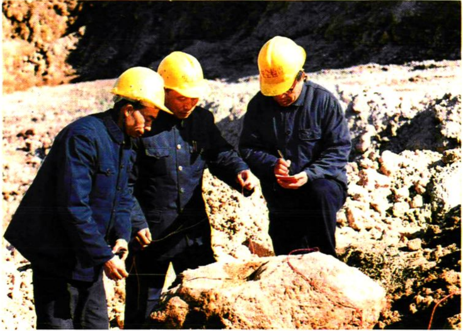
照 4 — 1 技术人员在应用莱矿国内首创的“水介质控制爆破”新技术为破碎矿石装药
