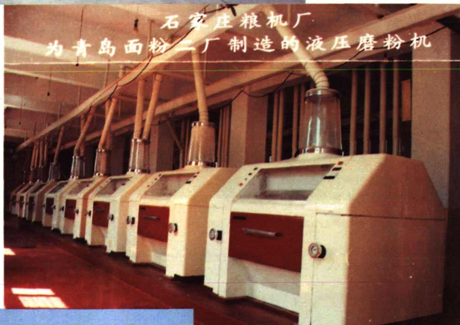
石家庄市等级面粉厂从英国西蒙公司引进的等级面粉生产设备(磨粉机部分)。
