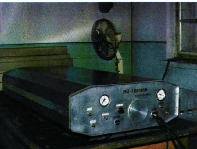
市电子技术研究所研究的 10 兆瓦氦分子激光器 (主机)
