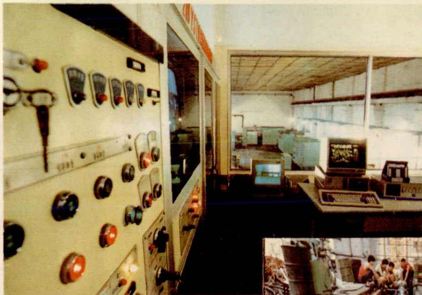
▲长江液压件厂研制的 YST-200 微机控制液压泵全性能试验台。
