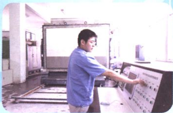
● 薄抹灰外墙保温耐候性检测
