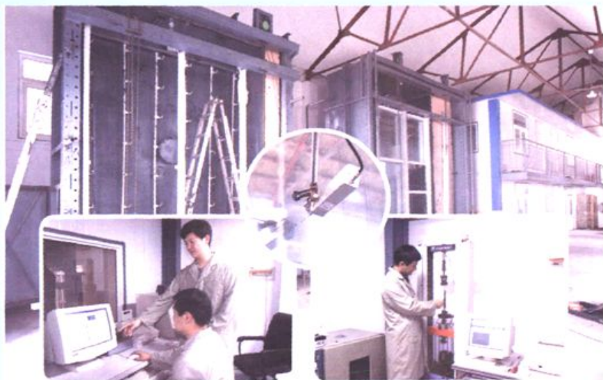
● 工作人员正在对玻璃幕墙进行检测
