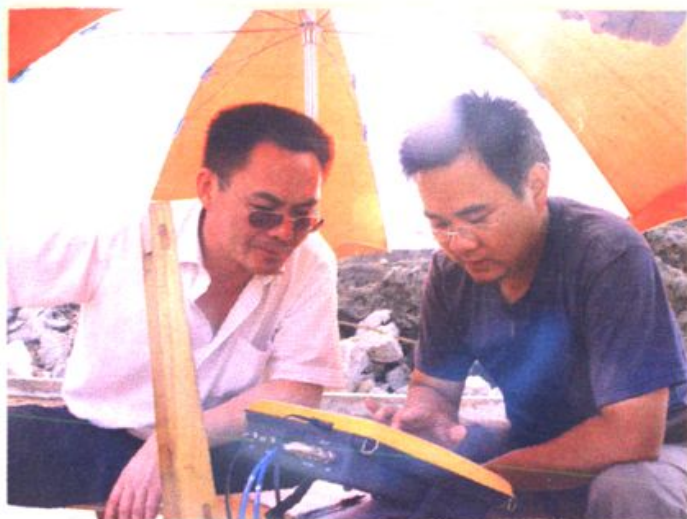
● 研究人员在工程现场进行超声波地基基础检测
