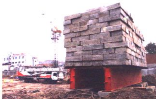
● 大吨位静载桩基检测现场
