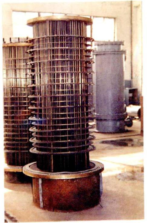
▶ 兴塔冷作厂生产的冷却器
