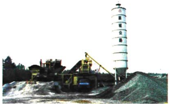
水泥混凝土拌和楼
