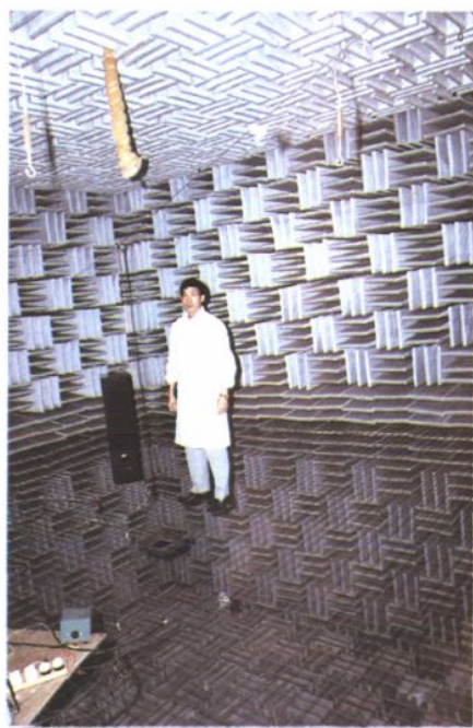
在消声室中对音箱性能进行测试
