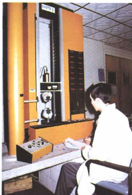
利用进口电子拉力试验机进行塑料样品测试
