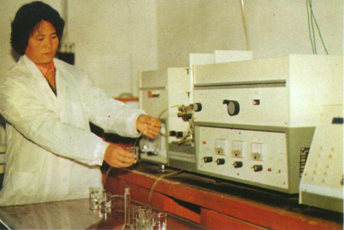
▲应用原子吸收光谱仪测量农作物微量原素含量
