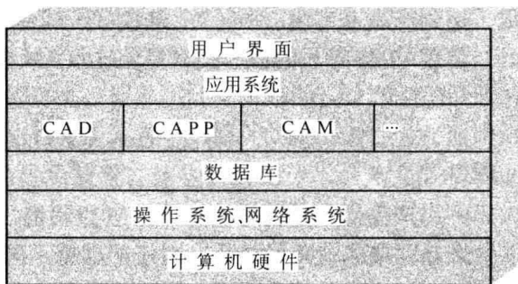
图 1-2 CAD/CAM 系统总体结构
