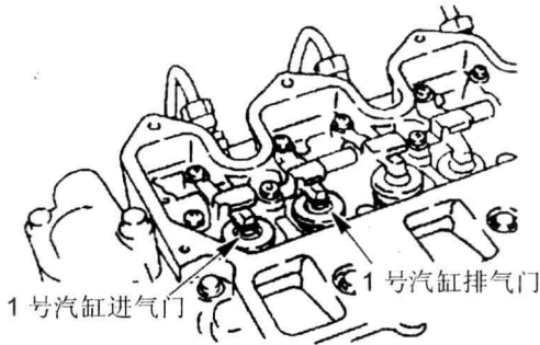
图 4-2-3 气门间隙的调整 (2)
