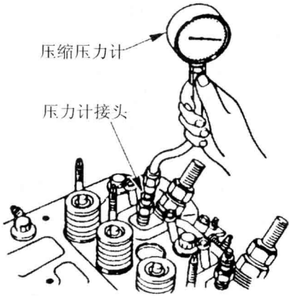
图 4-2-10 压缩压力的检测
