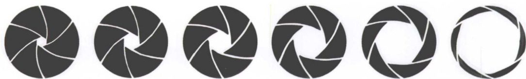
光圈大小示意图，光圈F值越小，开启的直径就越大，通光量也就越大
