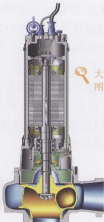
图2 排污泵:带单叶片叶轮的潜水排污泵
