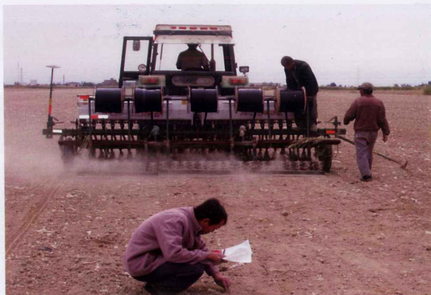
彩图4 兵团小麦滴灌栽培机械化播种铺带一条龙作业 (示一机铺五管、一管滴灌六行小麦)
