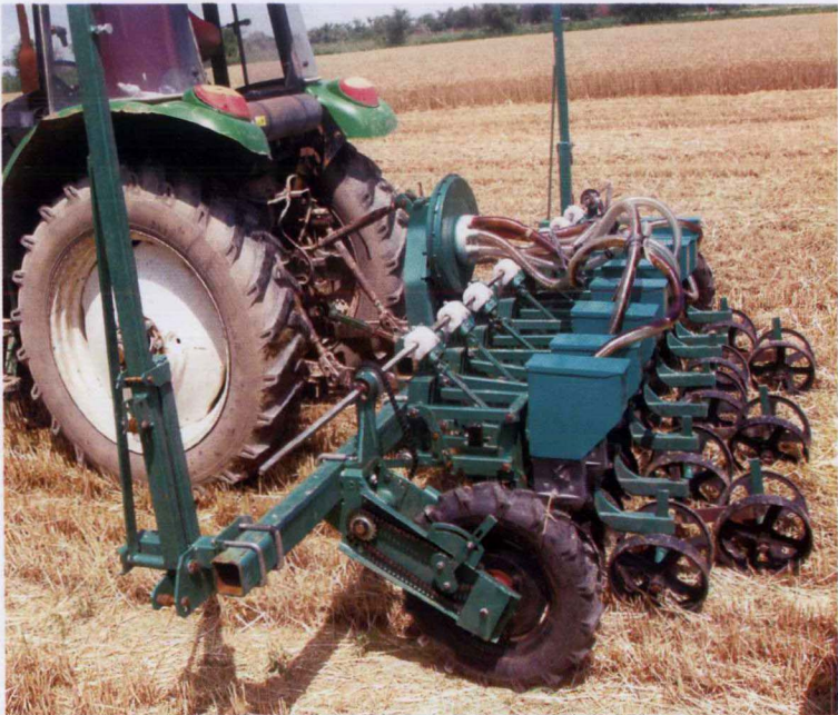
彩图6 麦茬免耕复播滴灌作物播种机
