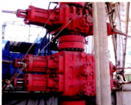
图 1-1-10 旁侧孔面向井架大门 (图二)
