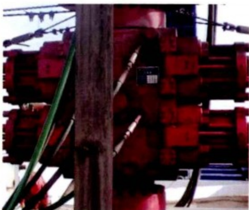
图 1-1-12 旁侧孔和液压管线接口面向大门 (图二)
