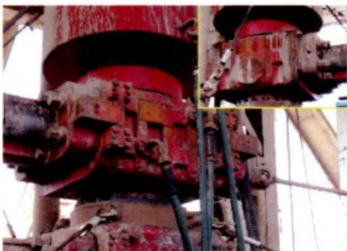
图 1-1-16 无旁侧孔防喷器
