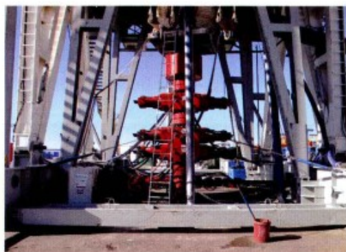
图 1-1-6 空间宽敞的电动钻机底座 (图二)
