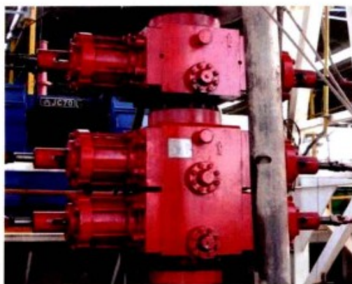
图 1-1-9 旁侧孔面向井架大门 (图一)
