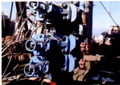
图 1-1-18 旁侧孔接防喷管汇
