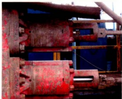
图 1-2-5 关井时手动操作杆脱开锁紧轴
