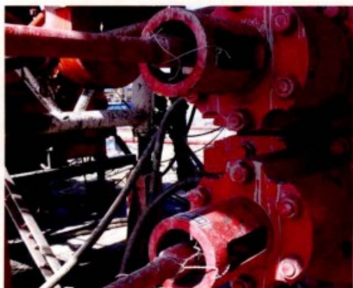
图 1-2-6 手动操作杆依靠铁丝固定
