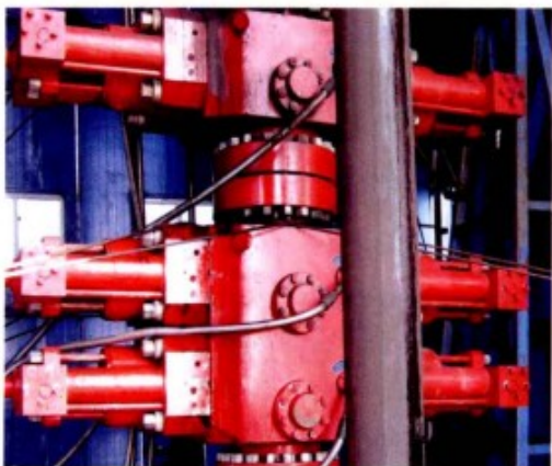
图 1-1-11 旁侧孔和液压管线接口面向大门 (图一)
