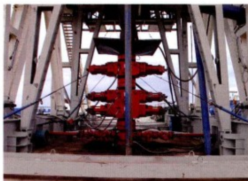
图 1-1-5 空间宽敞的电动钻机底座 (图一)
